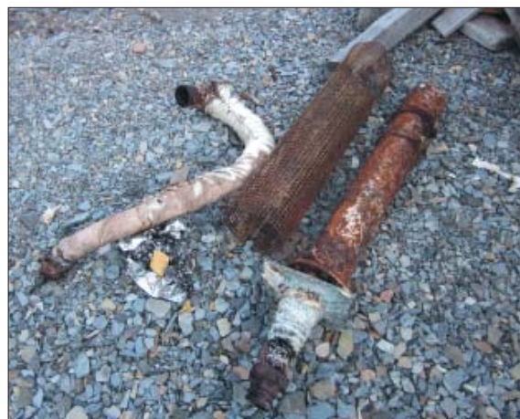
T.v. Aage udskifter det defekte udstødningsrør på "Agsut". I midten: De defekte dele. T.h. Det nye udstødningsrør monteret på "Agsut".
