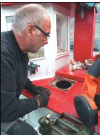
T.v. Aage udskifter det defekte udstødningsrør på "Agsut". I midten: De defekte dele. T.h. Det nye udstødningsrør monteret på "Agsut".
