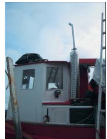
T.v. Aage udskifter det defekte udstødningsrør på "Agsut". I midten: De defekte dele. T.h. Det nye udstødningsrør monteret på "Agsut".
